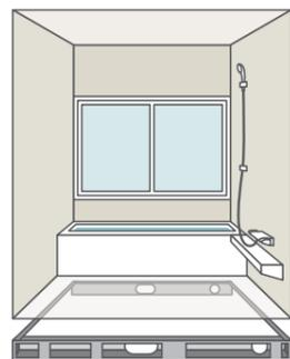
フレーム構造の架台で支えるので震度6強相当の振動にも負けない
